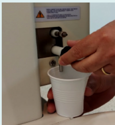
Figura 5. Llave de desagote interno
