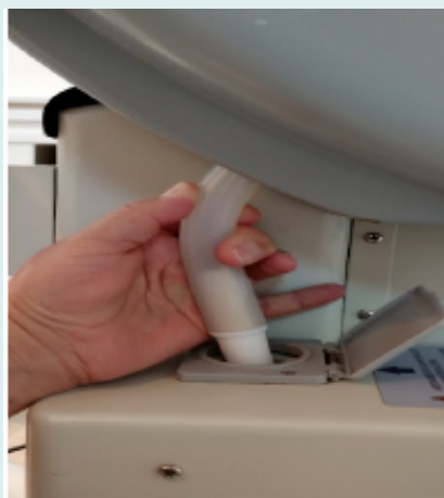
Figura 6. Conector de alimentación de humedad, que dirige la humedad del reservorio al habitáculo donde se encuentra el recién nacido
