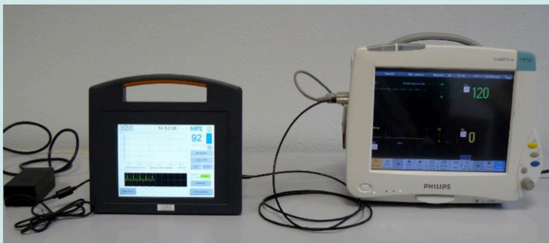
Figura 4. Conexión entre el monitor de signos vitales y el NIPE
